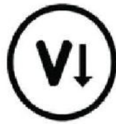
Under voltage Protection حفاظت افت ولتاژ
