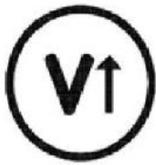
Over voltage Protection حفاظت اضافه ولتاژ
